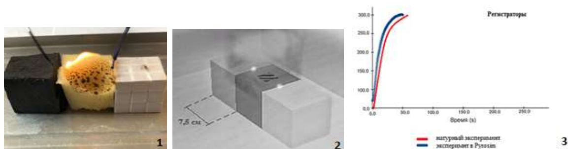
Рис. 2. Моделирование горения автомобиля (горение кубического модуля из поролон)
