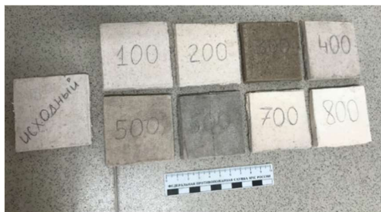
Рис. 4. Образцы после обжига в муфельной печи (примечание: цифрами обозначены температурные значения для обжига в °C)
